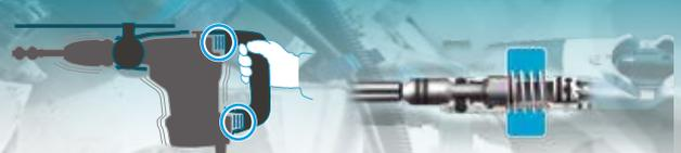
Varios muelles absorben las vibraciones producidas en el agarre de la herramienta.
