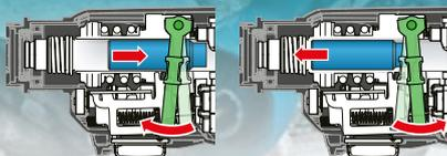
El cambio de la presión del aire en el pistón controla el amortiguador y lo mueve en dirección contraria al pistón consiguiendo contrarrestar las vibraciones producidas por este.
