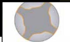
El diseño simétrico de las 4 espirales aseguran que el desgaste sea bajo y uniforme.
