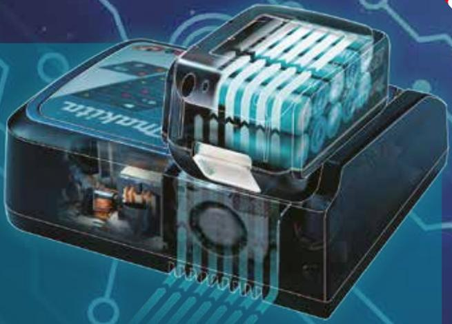
**Sistema óptimo de carga.** Enfriamiento por aire forzado. **Sistema de carga general.** Enfriamiento natural.
