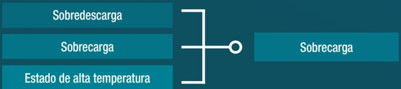
Esta función es la tecnología de comunicación que permite la herramienta y la batería para monitorizar las condiciones e intercambiar datos en tiempo real. De esta forma se protege contra sobrecarga y sobrecalentamiento.
