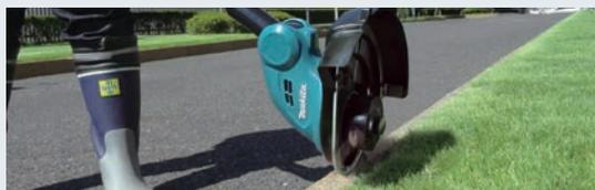
Podemos girar el cabezal 180° para recortar bordes con facilidad.
